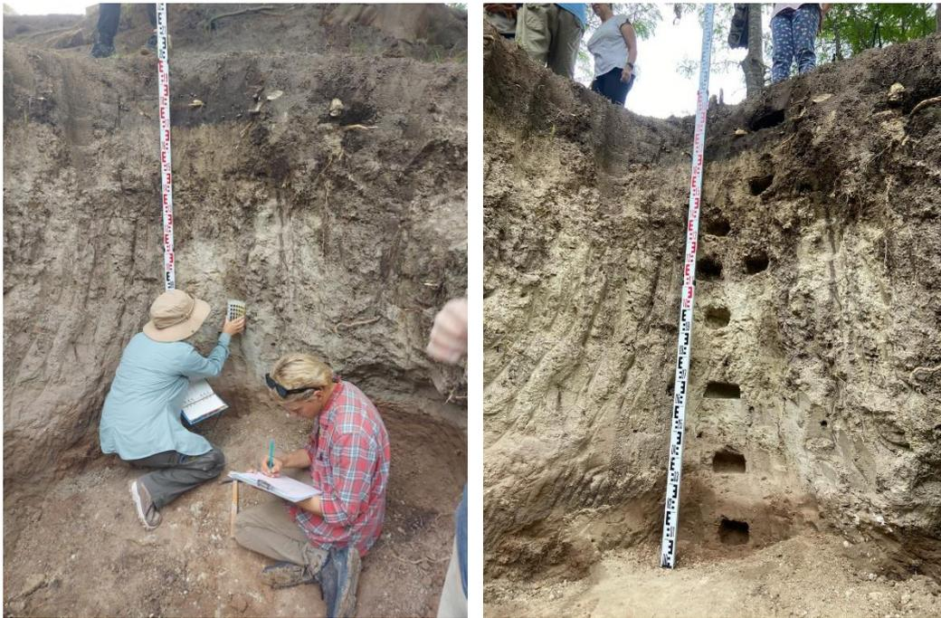
**Figura 4: Relevamiento y muestro del perfil estratigráfico.**
